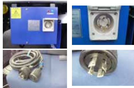
◎スタンバイ200V/30A(外部電源)
